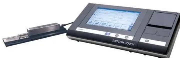
Рис. 53 Портативный профилометр Accretech Surfcom Touch 35
