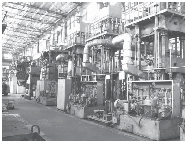
Рис. 73 Общий вид участка изотермической штамповки (вид сзади), оснащенного изотермическими установками, выполненными на базе гидравлических прессов с номинальной силой 6,3 МН (630 тс)
