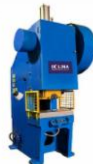
Рис. 11 Кривошипный горячештамповочный пресс
