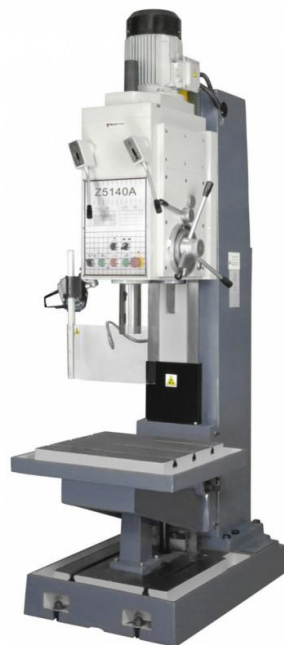
Рис. 32 - Станок вертикально-сверлильный Z5140A
