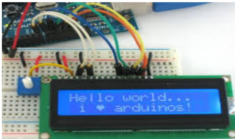
Рисунок 2. Подключение жидкокристаллического дисплея к монтажной плате.
