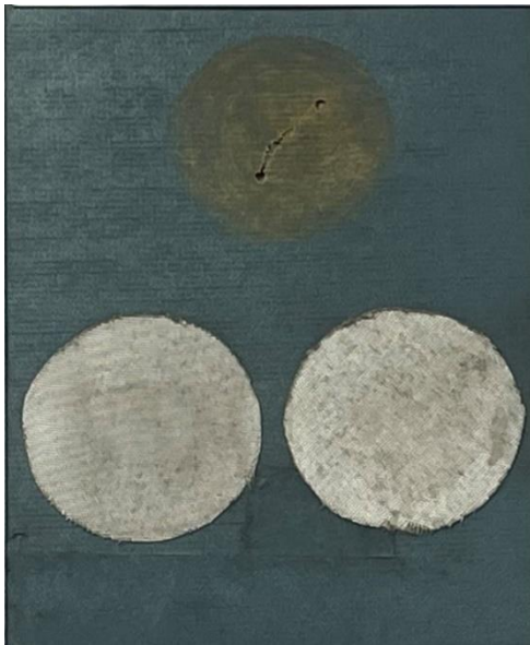
Рисунок 6 – Ремонт трещины многослойных конструкций носового обтекателя
