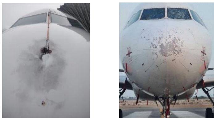
Рисунок 2 – Повреждение носового обтекателя молнией и градом
