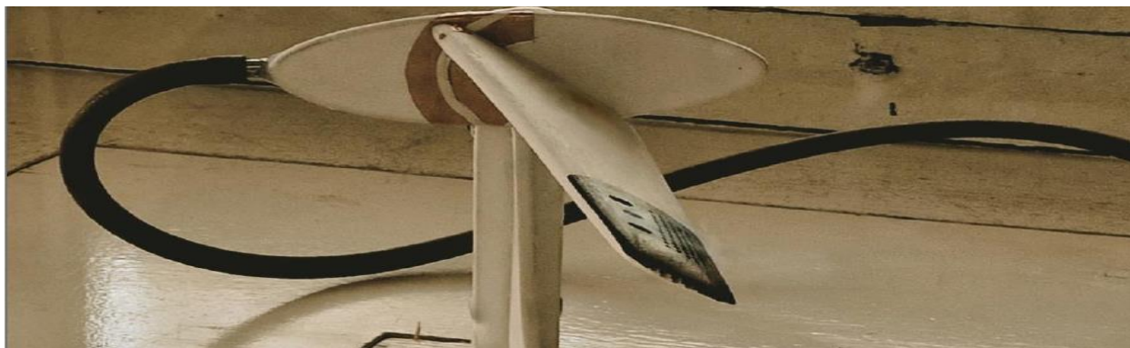
Рисунок 7 – Характер обтекания законцовки крыла на больших сверхкритических углах атаки
