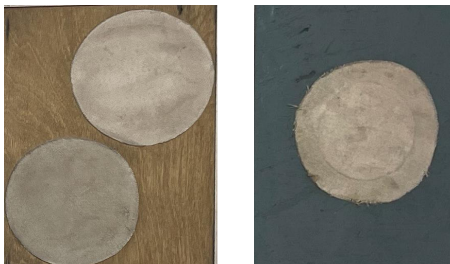
Рисунок 9 – Наклейка второго слоя заплат из стеклоткани
