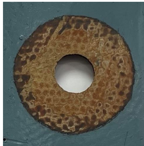
Рисунок 7 – Сквозное повреждение трехслойной конструкции с сотовым наполнителем
