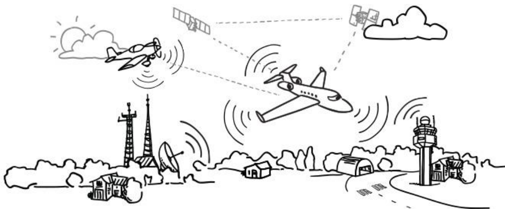
Рисунок 2 – Схематичное изображение взаимодействия в системе АЗН-В. Источник: https://skalolaskovy.ru
