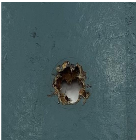
Рисунок 7 – Сквозное повреждение трехслойной конструкции с сотовым наполнителем
