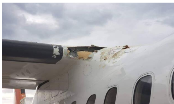
Рисунок 2 – Результат попадания молнии по композитной обшивке. Источник: https://earth-chronicles.ru/news/2019-11-27-134920
