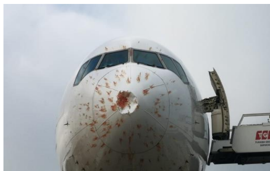
Рисунок 1 – Повреждения носового обтекателя после столкновения с птицами
