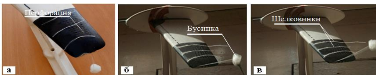
Рисунок 8 – Управление срывным режимом законцовок крыла: а – модель в покое; б – малый угол атаки; в – срывной угол атаки
