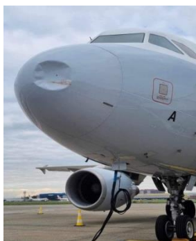
Рисунок 1 – Повреждения носового обтекателя после столкновения с птицами
