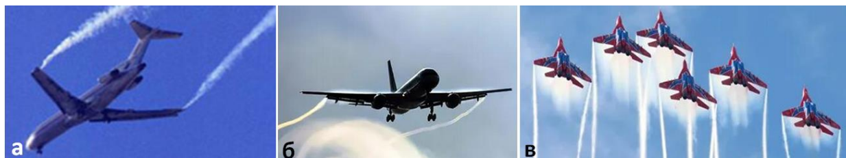
Рисунок 2 – Торцевые вихри крыла (а). Источник: https://cs6.pikabu.ru/post_img/2017/08/16/10/1502903279123789279.jpg ; закрылков (б), Источник: https://cs6.pikabu.ru/post_img/2017/08/16/10/1502903279123789279.jpg ; и истребителей (в), Источник: https://avatars.mds.133andex.net/i?id=8d933ae9c2049fcf6936fc31be7c94c6615c4a-10878446-images-thumbs&n=13/
