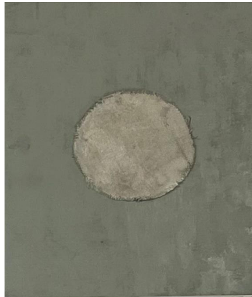
Рисунок 6 – Ремонт трещины многослойных конструкций носового обтекателя
