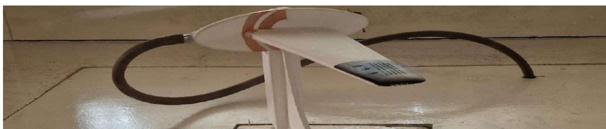
Рисунок 5 – Режим безотрывного обтекания спинки крыла при нулевом угле атаки с отсосом и сливом отсасываемого пограничного слоя через торцевую перфорацию в окружающую среду
