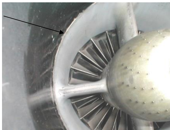
Рисунок 4 – Повреждения и забоины лопаток РК I ступени компрессора
