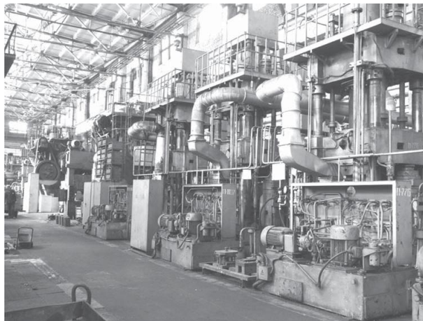
Рис. 73 Общий вид участка изотермической штамповки (вид сзади), оснащенного изотермическими установками, выполненными на базе гидравлических прессов с номинальной силой 6,3 МН (630 тс)
