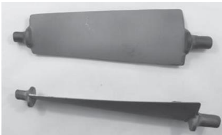
Рис. 75 Заготовки титановых лопаток авиационного двигателя, отштампованные в изотермических условиях
